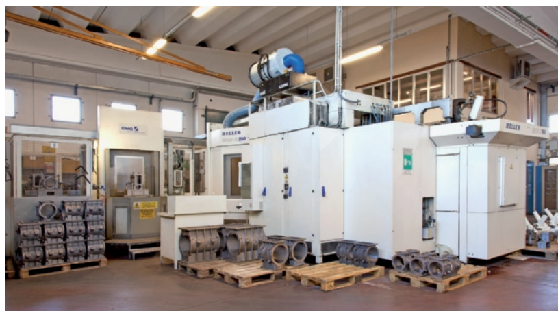
Vista del centro di lavoro orizzontale Heller MCS H 250 acquisito da Olocco nel 1997 e ancora oggi perfettamente funzionante.
